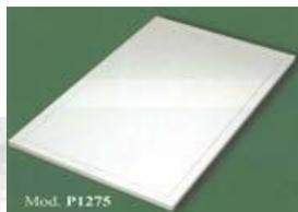
I piani di lavoro in polipropilene sono realizzati con supporto poliuretano idrofugo ed ignifugo classe 1 oppure agglomerati di legno e resine, dello spessore di mm. 36 sul qual è applicata con speciali collanti una lastra in polipropilene dello spessore di mm.4; n'è pertanto uno spessore finito di mm. 40 (inclusa la bordatura perimetrale sopraelevata di contenimento).
