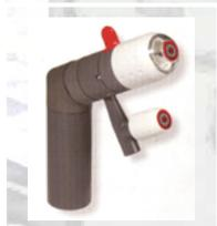
Le prese d'erogazione per gas tecnici, sono riduttori di II° stadio provvisti di rubinetto a spillo per la regolazione fine della portata, con indicazione visiva con scala graduata posta su apposito manometro.
