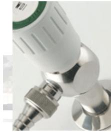
La rubinetteria per acqua è dotata di vitone a bagno d'olio e tenuta in EPDM, portagomma smontabile secondo la norma DIN 12898, maniglie secondo la norma DIN 12920 prodotte in Moplen (materiale resistente agli acidi), filettature secondo la norma ISO228/1 classe di tolleranza B, pressione massima d'utilizzo 10 bar.
